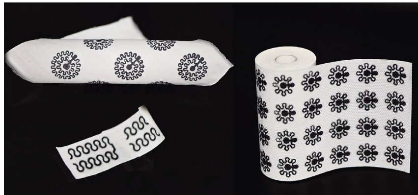
以葡萄糖为能量来源的可生物吸收的柔软电子绷带原理图。 中国科学院大学供图
