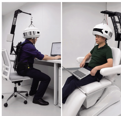
头戴随动式脑 PET 系统在坐位扫描、背包式支撑及自然坐姿方面的使用场景。 研究团队供图
